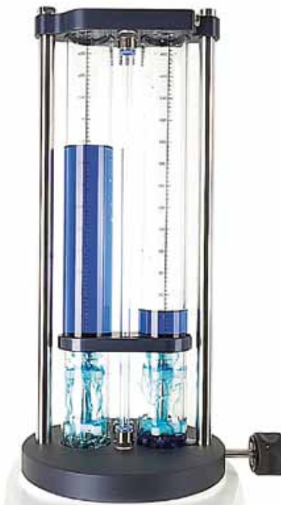
Durchflussvergleich einer herkömmlichen Filtertresse DTW-S (links) und einer RPD HIFLO-S (rechts) mit jeweils 15 \mu\text{m} Porengröße.
