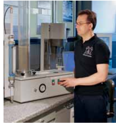
Das HAVER-Entlüftungsmessgerät untersucht das Be- und Entlüfteeverhalten von pulverförmigen Schüttgütern.
