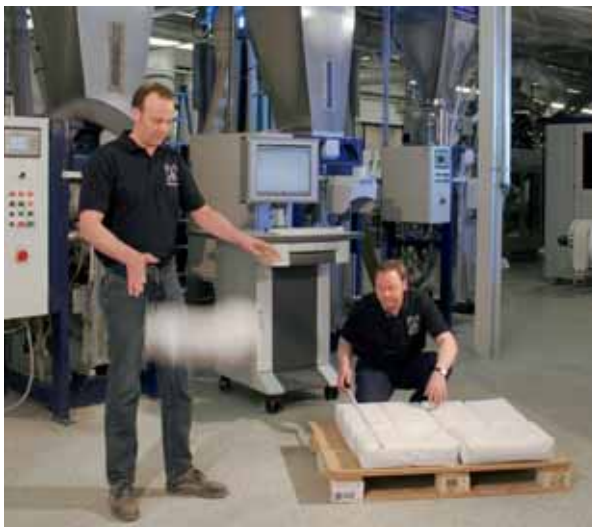
Ein Falltest prüft die Bruchfestigkeit der Schweißnaht.
