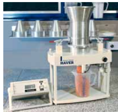
Der HAVER-Rieseltester bestimmt die Fallgeschwindigkeit und Rieselfähigkeit von körnigen Schüttgütern.
