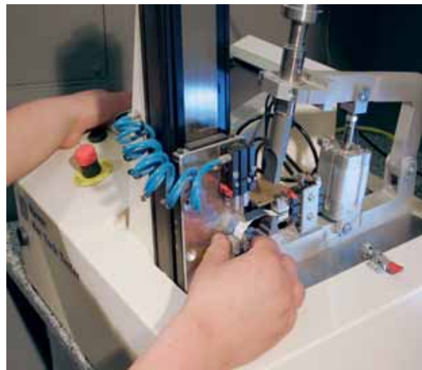
Der HAYER-Hot-Tack-Tester prüft die Belastbarkeit der Schweißnähte
