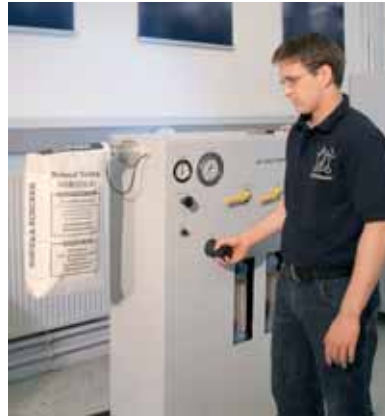
Der HAVER-Airflow Tester bestimmt die Entlüftungsfähigkeit von Ventilsäcken.
