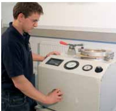
Der HAVER-BIG GURLY misst die Luftdurchlässigkeit und bewertet die Sackmaterialien.
